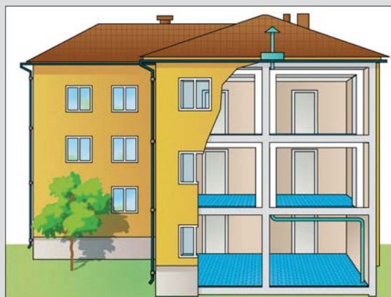
3. Usean kerroksen liittäminen olemassa olevaan ilmastointijärjestelmään
